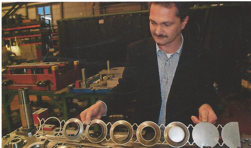
Thomas Schumacher mit einem Teststreifen und dem Unterteil des zugehörigen Folgeverbundwerkzeugs. Kein Werkzeug geht ohne Umformsimulation in die Werkstatt.
