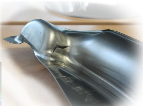
Bild 2. Mithilfe der Umformsimulation lassen sich die kritischen Bereiche sicher vorhersagen. Hier ist der Riss sowohl in der Software als auch am Bauteil deutlich zu erkennen.
